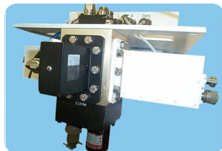
Система резервированных 1:1 блоков LNA
