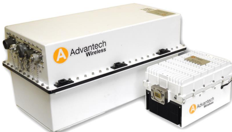
Рисунок 2. Сравнительная фотография усилителей Ku-диапазона 50Вт – слева SSPA на GaAs (выпуск 2006 года), справа SSPA на GaN (выпуск 2010 года).
